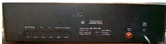
Тут входы для двух магнитофонов, тюнера (ака радио) и электрофона, а так же выход на усилитель, под маркировкой УМ. Под коричневой крышечкой скрывается предохранитель.
